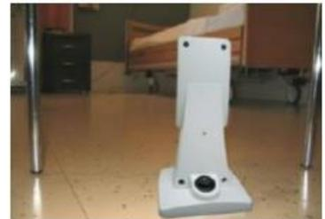
1. Melden Sie den integrierten Ascom Funksender (NITX-BAA) bei Ihrem Ascom teleCARE IP Patientenrufsystem an (dazu ist eine Funkabdeckung notwendig). Die Identifikationsnummer des Funksenders befindet sich hinten auf dem Bewegungsmelder.
